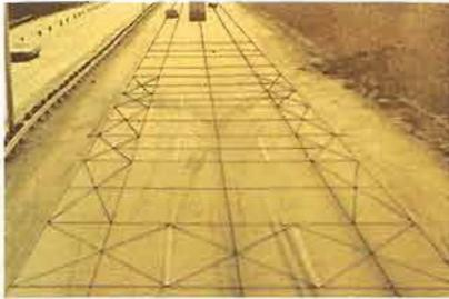
FIG. 24.—Utilización de las marcas de separación de carriles como referencia para la aplicación del método del malla.
