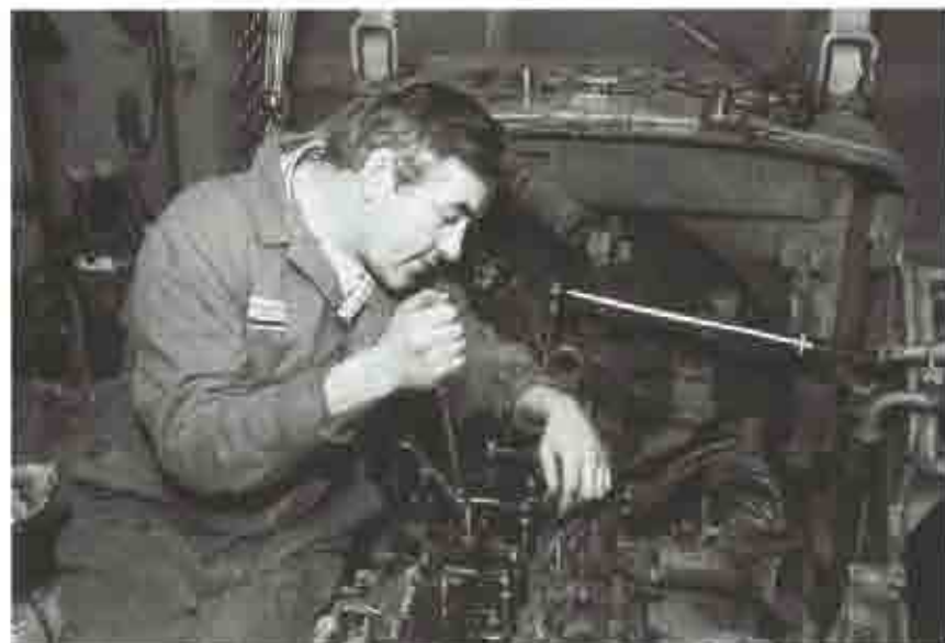
El mantenimiento preventivo, consiste en someter a las máquinas a una revisión periódica y proceder a la reparación de los defectos encontrados.
