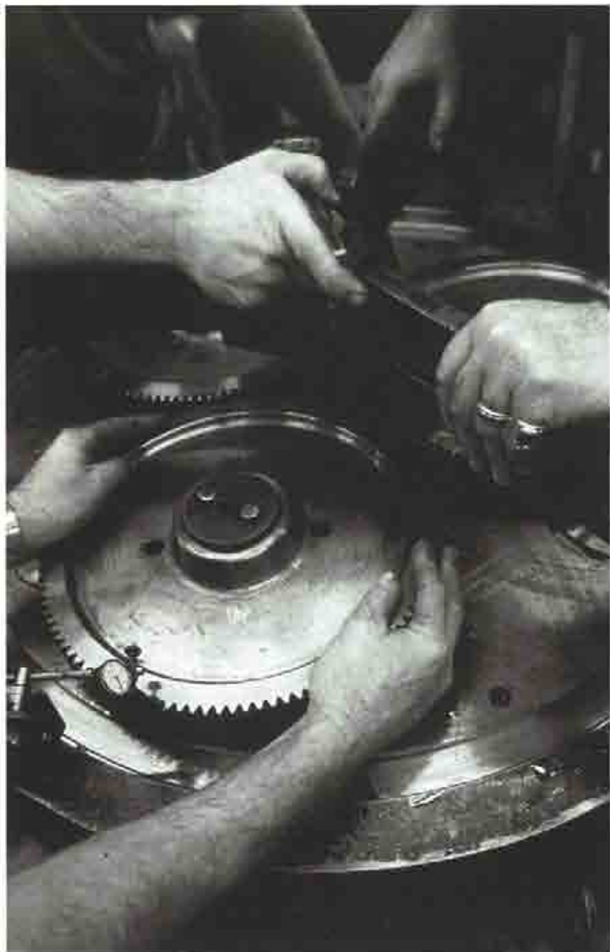
Los engranajes defectuosos son una de las mayores fuentes de producción de ruidos y vibraciones.
