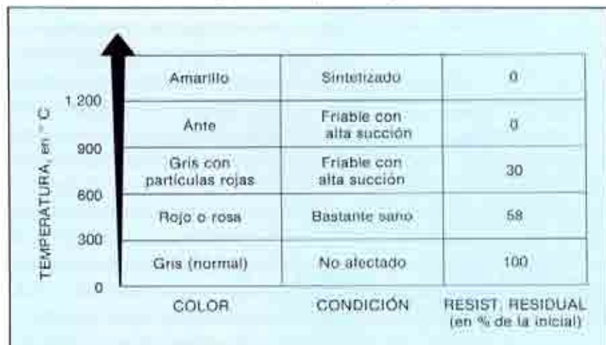
FIGURA 11. Relación entre la temperatura sufrida, el color alcanzado y la resistencia residual del hormigón afectado por el fuego.
