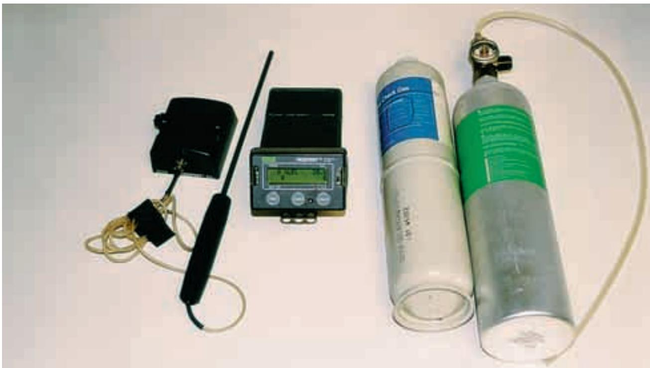
Para que los equipos de medición continua proporcionen resultados fiables es necesario comprobar rutinariamente la precisión de su respuesta mediante gases de concentración contrastada.
