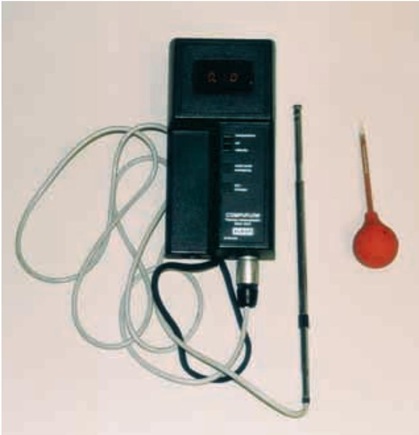
Los anemómetros y trazadores fumígenos permiten comprobar la calidad de la ventilación existente, tanto por la intensidad del flujo de aire como por el barrido efectivo de las zonas de exposición.
