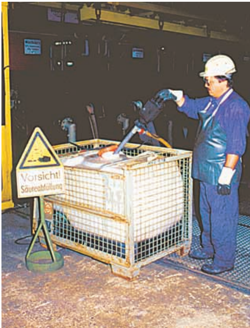
Riesgo de proyección de ácido sobre cara y antebrazos durante la manipulación de un ácido.
