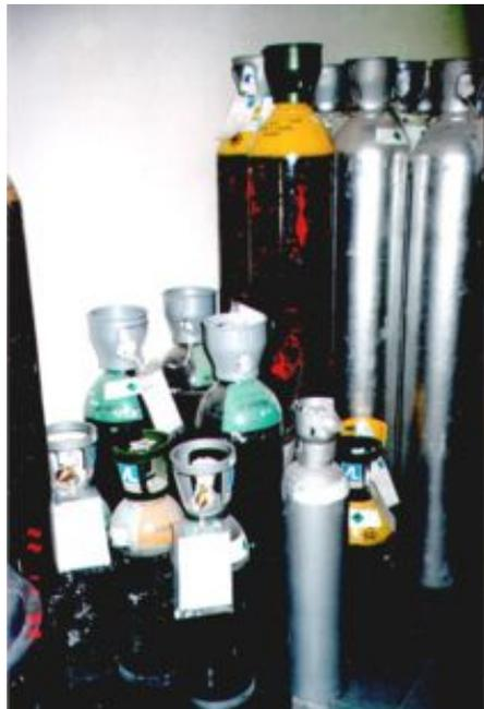
Las botellas se almacenarán siempre en posición vertical, y debidamente sujetas a una pared o superficie sólida, por ejemplo mediante cadenas o abrazaderas, para impedir su caída y evitar así posibles daños en las válvulas.
