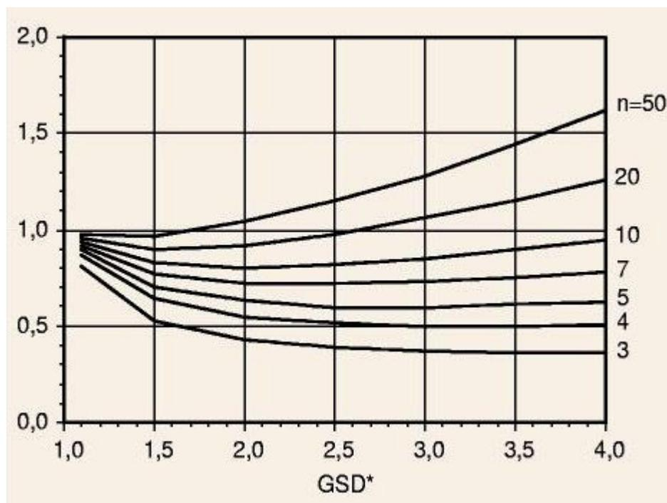
El límite inferior del intervalo en el que se encuentra la media se obtiene al multiplicar la media geométrica por el factor  $F_{inf}$  extraído de la figura y cuyo valor se indica en el eje de ordenadas.
