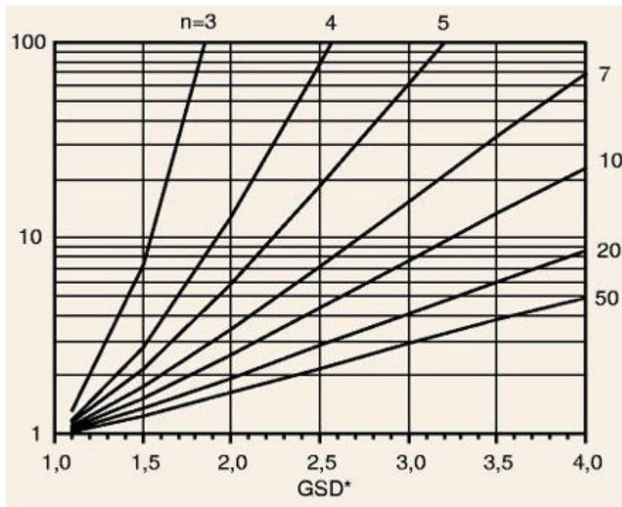
El límite superior del intervalo en el que se encuentra la media se obtiene al multiplicar la media geométrica por el factor  $F_{sup}$  extraído de la figura, y cuyo valor se indica en el eje de ordenadas.
