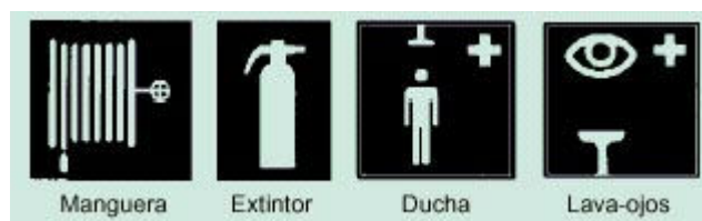
Fig. 6: Señalización de los elementos de actuación
