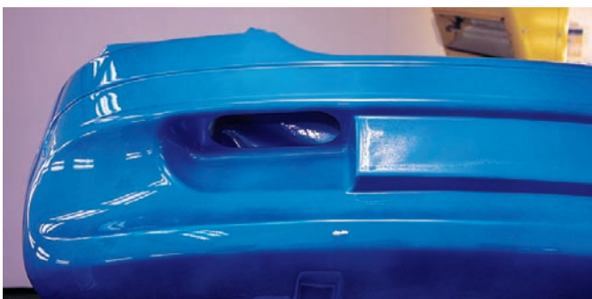
Aspecto lechoso de la capa de barniz antes de su secado
