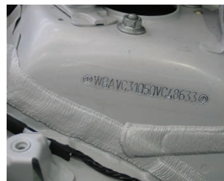
VIN troquelado en la torreta de suspensión derecha
