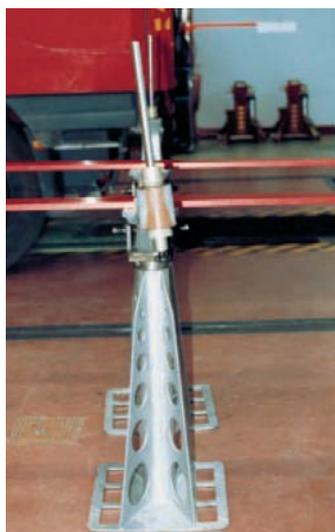
Control del desplazamiento del pivote
