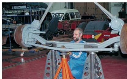
Desmontaje y desguazado del eje
