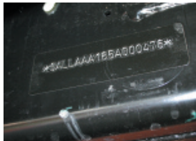
Localización del número de bastidor en el larguero del chasis y en el tablero de a bordo (a la izquierda)
