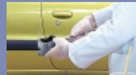
4. Aplicar disolvente de óxido y sulfuros (Contacto OL) y dejar actuar (15 minutos).
