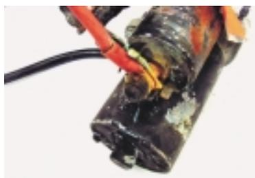
Conector +30 de un motor de arranque
