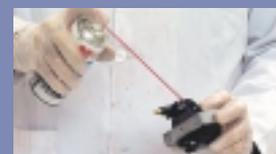
6. Aplicar laca protectora (Contacto SL) a toda la pieza, para evitar que actúe la humedad.
