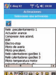
Activación de los actuadores
