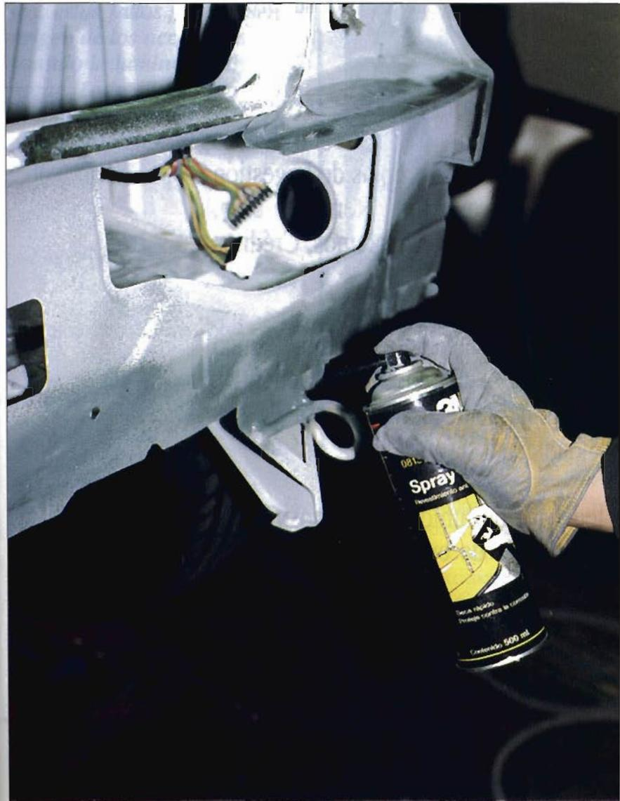
Aplicación de protección anticorrosiva previa a la ejecución de la soldadura.
