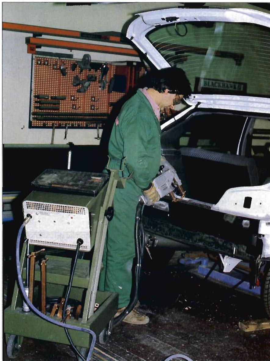
**P**ara la fabricación actual de las carrocerías de automóviles, se parte de una serie de piezas, generalmente metálicas, con unas dimensiones, geometría y espesor determinados. Para conformar la carrocería se procede al ensamblaje de todas esas piezas entre sí.
