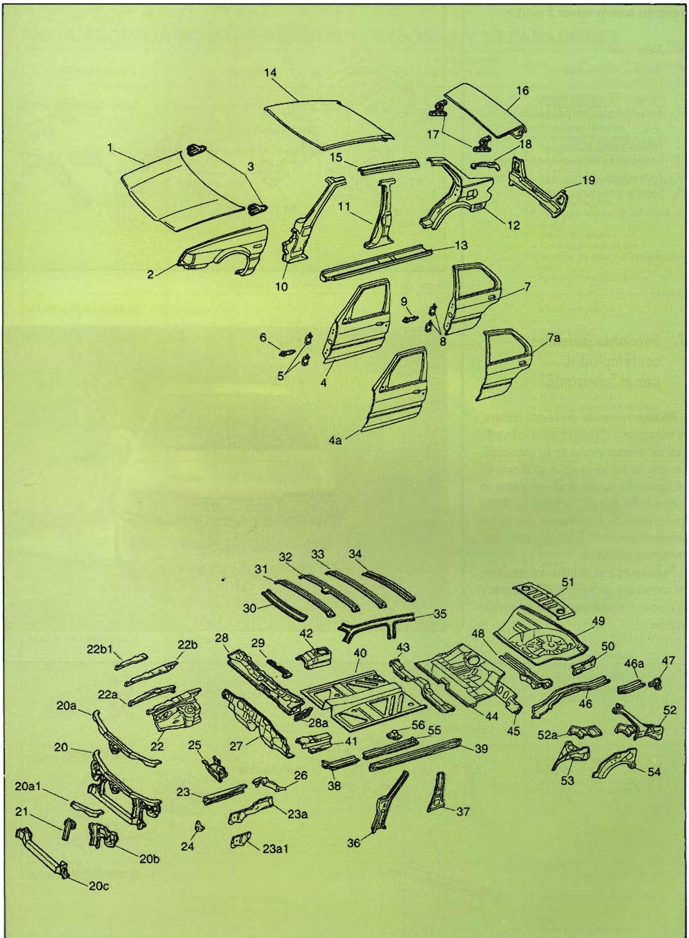
Figura 7a Despiece de la carrocería.
