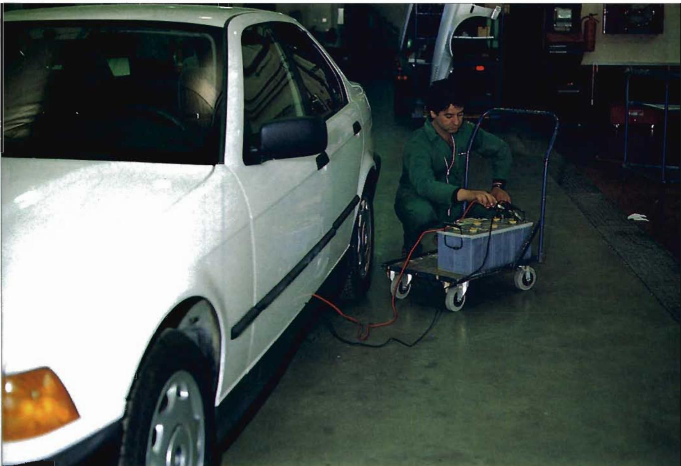
▲ *Para la correcta activación eléctrica de los sistemas airbag, los talleres deberán disponer del equipo especial recomendado por el fabricante.*
