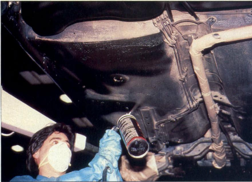
Aplicación de revestimientos de bajos en el piso de un vehículo
