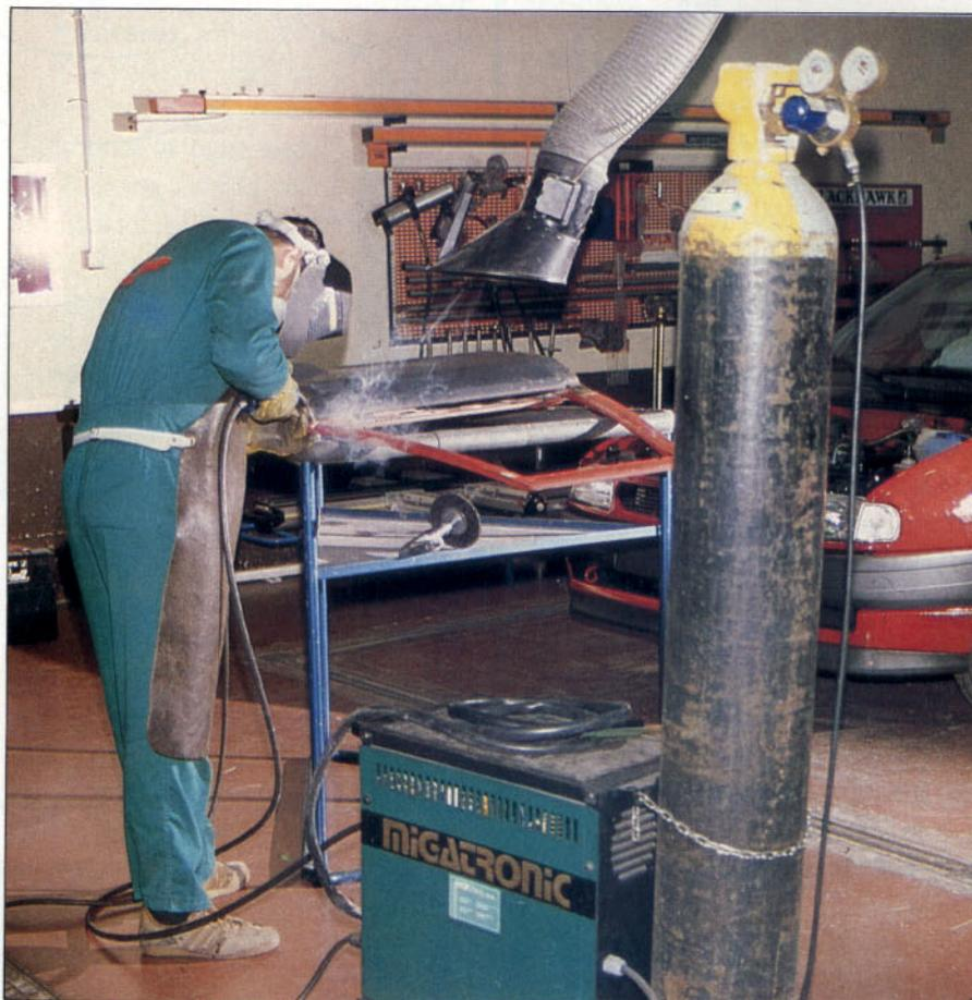
**L**os gases empleados en operaciones de soldadura están envasados en recipientes portátiles que permiten su acoplamiento a los equipos de soldadura o en carros especiales pensados para facilitar su desplazamiento por todo el taller.
