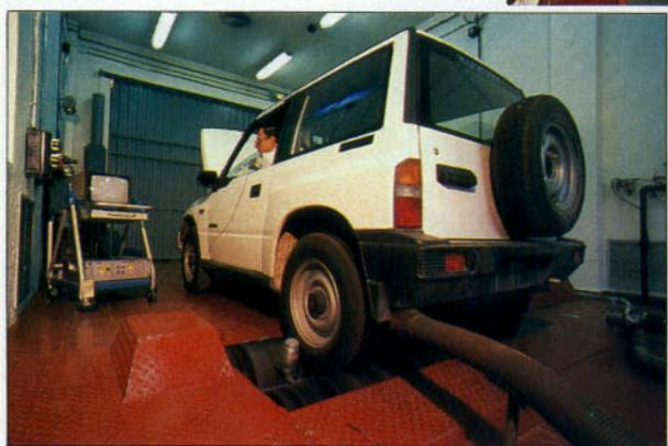
Ensayo de contaminación con motores
