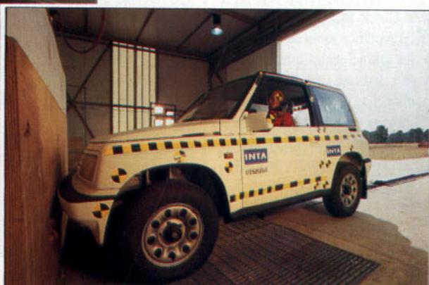
Prueba de impacto frontal de un vehículo contra un muro rígido
