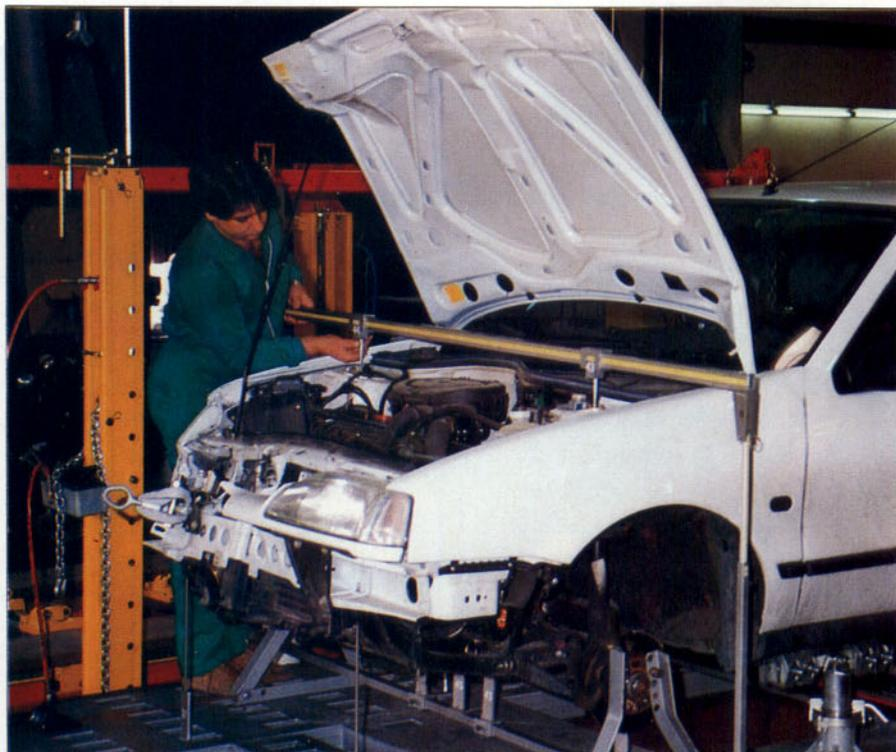
Medición de la parte superior de la carrocería
