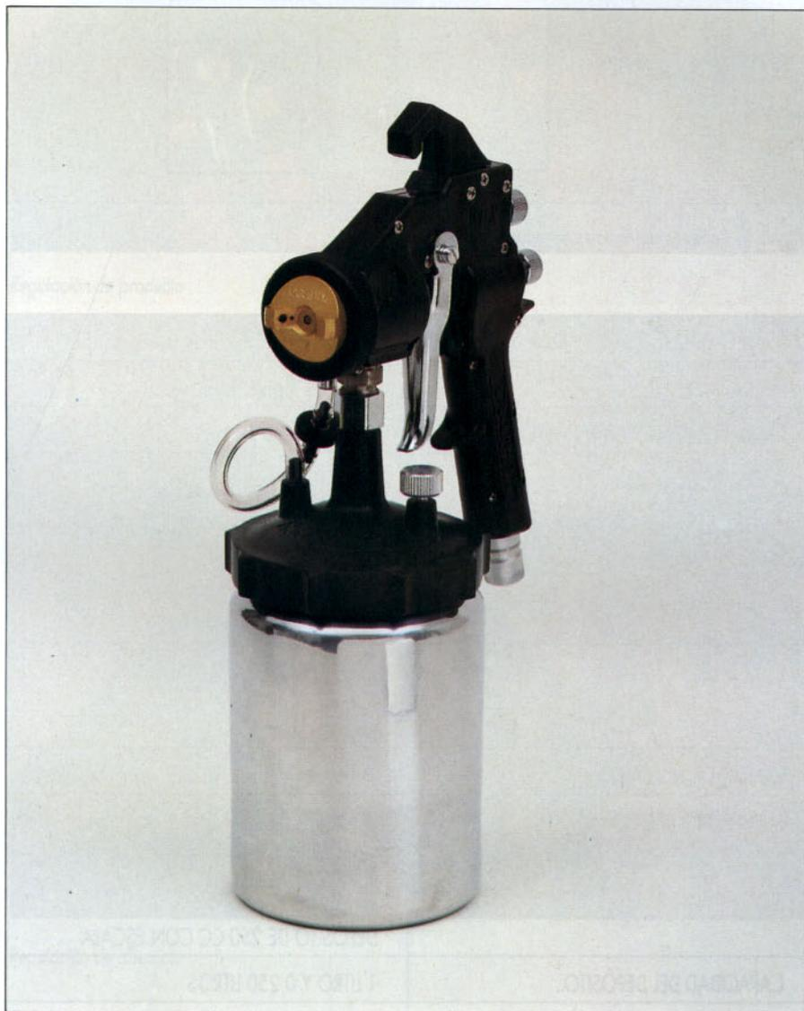
**S**e trata de un equipo aerográfico de alto volumen y baja presión (A.V.B.P.® en la terminología de este fabricante y HVLP en otros), cuya principal característica son sus conductos interiores sobredimensionados, que permiten al aire fluir sin oposición, entrando y saliendo con baja presión, sin aumento de velocidad y sin turbulencias.
