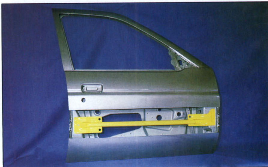
Barra de protección lateral en una puerta
