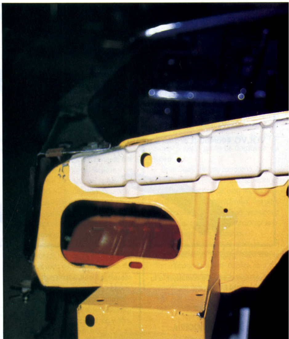
Adopción de puntos fusibles en el refuerzo de un pase de rueda
