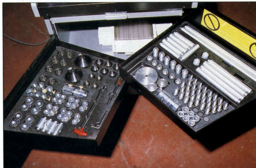
Accesorios para la fijación de las sondas a la carrocería
