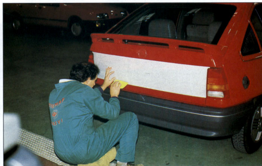
Con una espátula se eliminará el agua sobrante dejando el adhesivo fijado sobre la carrocería.
