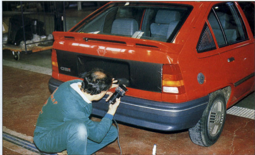
La dilatación del adhesivo con el soplete de aire caliente posibilitará su adaptación a la superficie.
