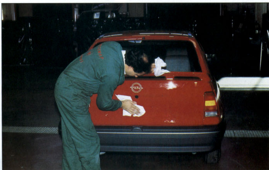
El desengrasado de la superficie donde ha de colocarse el adhesivo, asegurará su adherencia.
