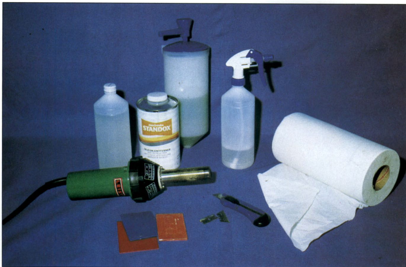
Materiales y productos necesarios para la colocación de adhesivos.
