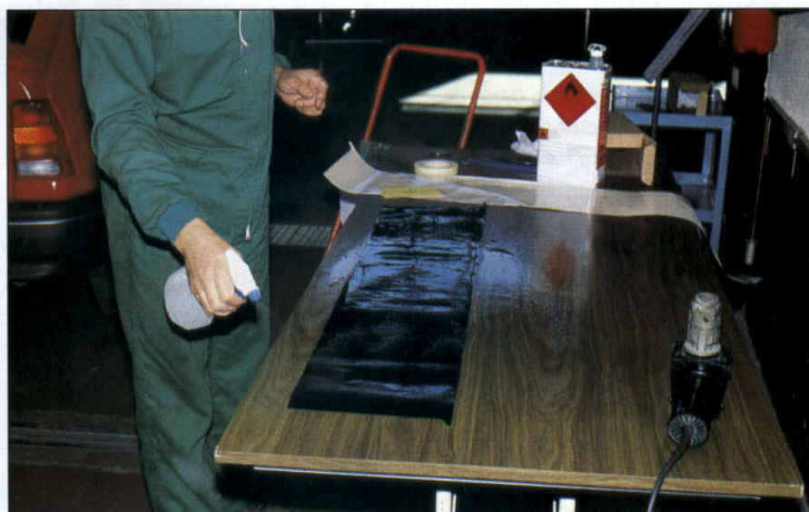
El rociado del adhesivo con una solución de agua jabonosa facilitará su colocación.
