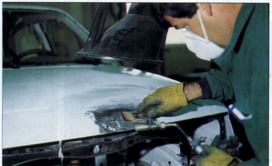
Conformación de la masa de estaño-plomo.
