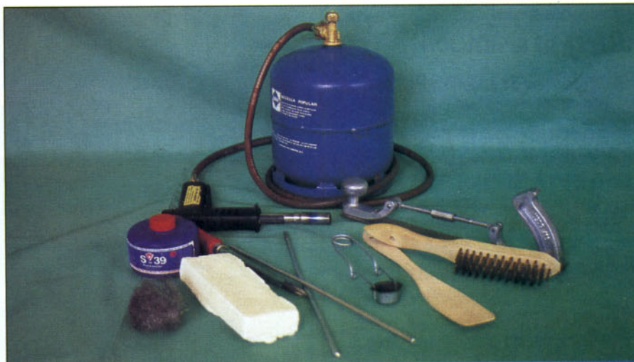
Materiales y equipos empleados en el estañado.
