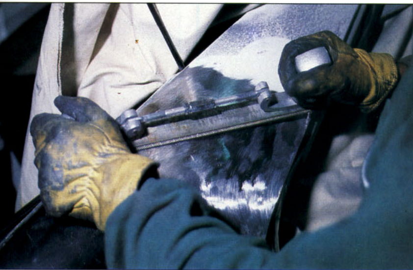
Eliminación de faltas con lima de carrocerero.
