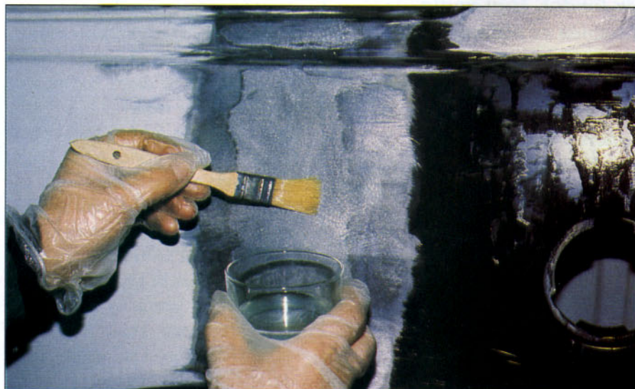
Neutralización del líquido de limpieza.
