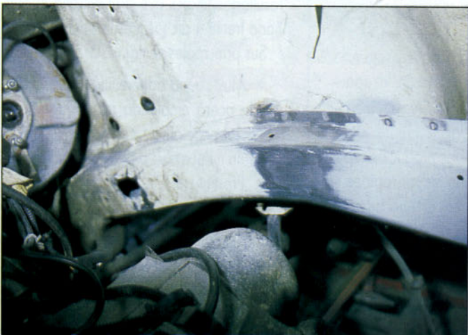
Diferentes reparaciones realizadas con soldadura blanda.
