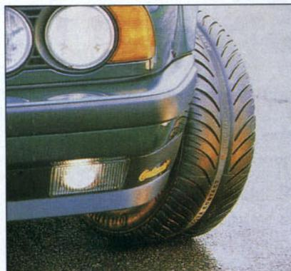
Neumáticos de banda de rodadura en «V» o partida.
