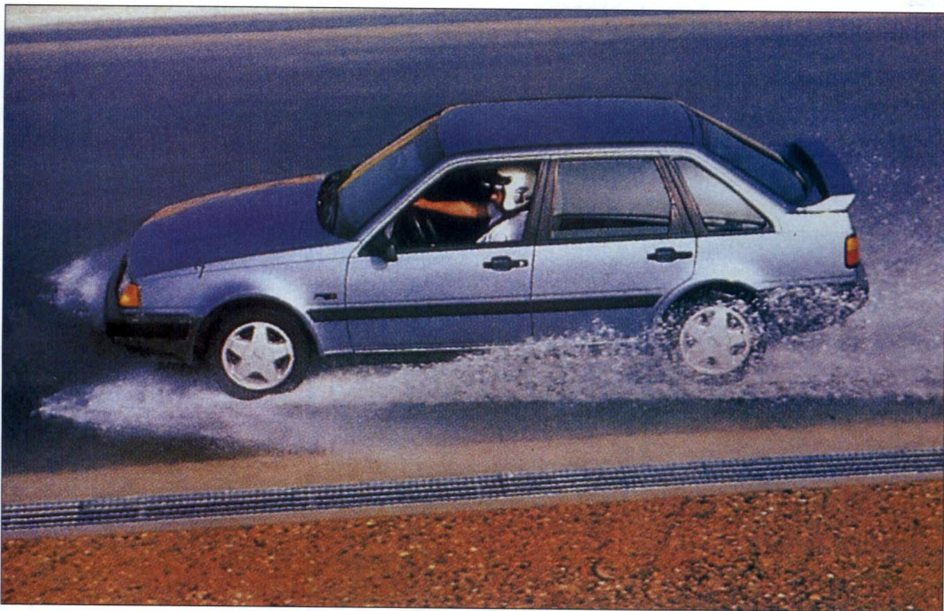
***El fenómeno del «aquaplaning» o hidroplaneo se produce cuando un neumático pierde el contacto con el pavimento a causa de la presión ejercida por el agua existente sobre la calzada, como consecuencia de una excesiva velocidad.***
