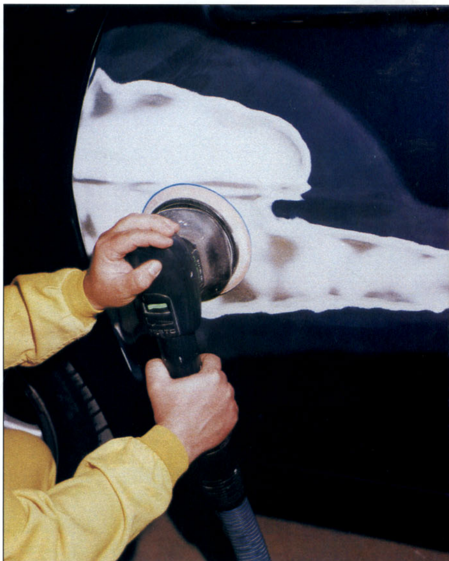
Lijado de la masilla.
