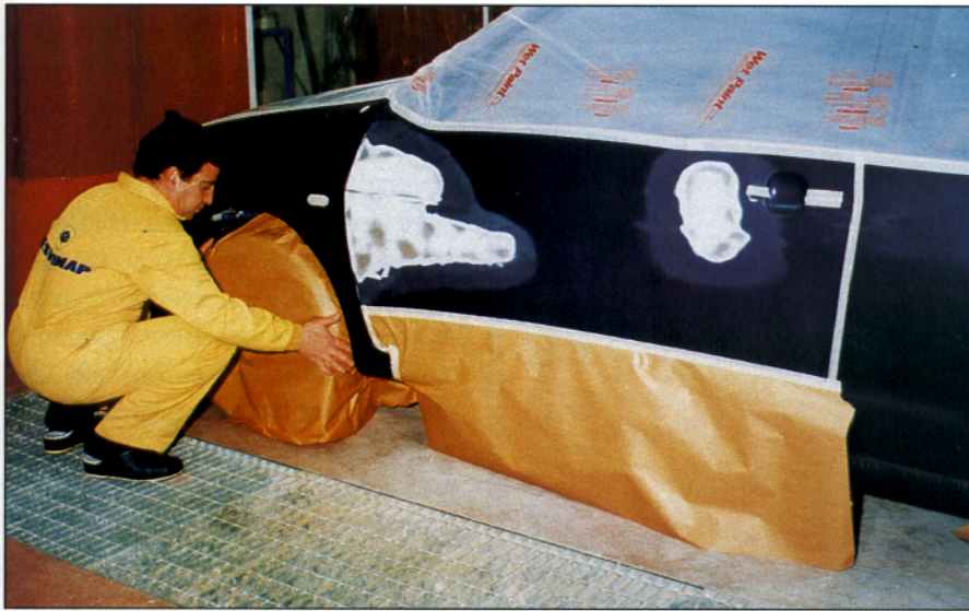
Protección de las zonas que no se van a pintar.
