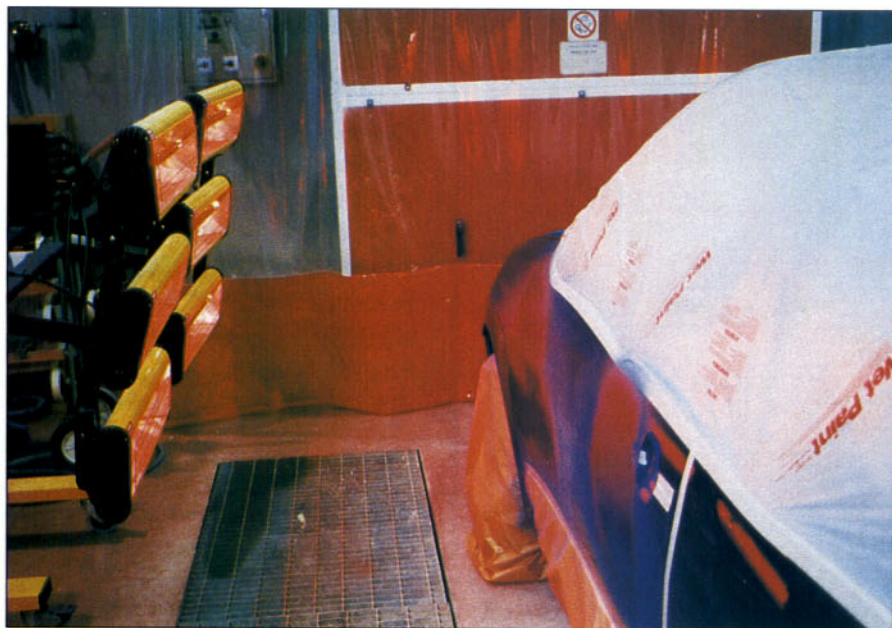
Secado del aparejo con equipo infrarrojos.
