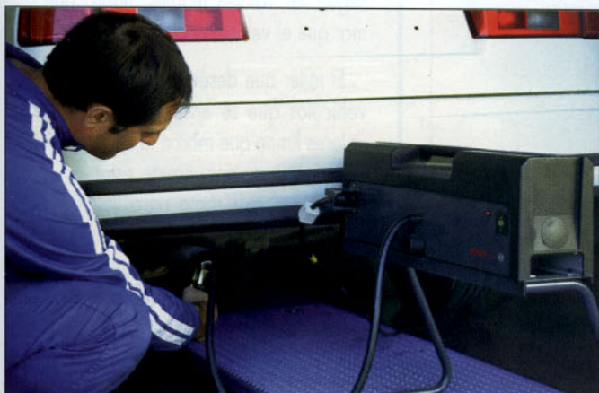
Instalación de la sonda en el tubo de escape.
