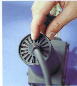
Rejilla reguladora del caudal de aire
