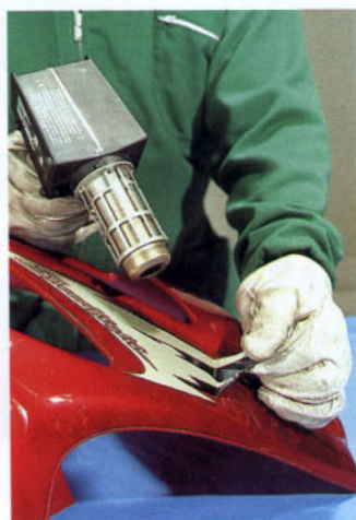
Eliminación de revestimientos (arriba) y de adhesivos de decoración (abajo)
