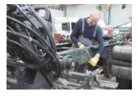
sí mismos o en sus uniones con los largueros, normalmente se pueden sustituir como una unidad. De esta manera, además, servirán como referencia dimensional para otros elementos deformados.
