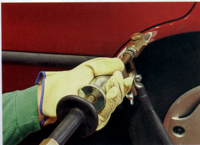
Desabollado rápido con martillo de inercia
