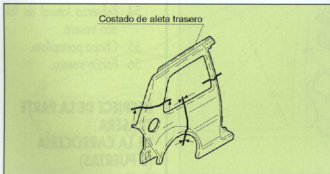
Figura 13. Sustituciones parciales contempladas por el fabricante (versión 3 puertas)
