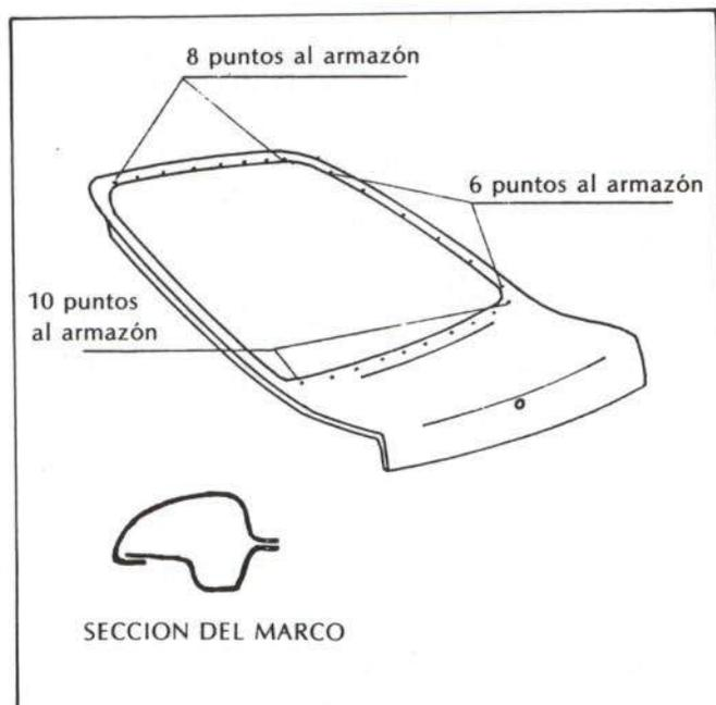
Fig. 44.—Fijación del panel del portón.
