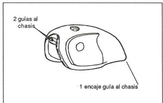
Figura 29.- Fijación del depósito de combustible
