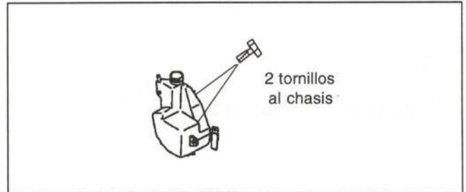
Figura 39.- Unión del depósito de agua
