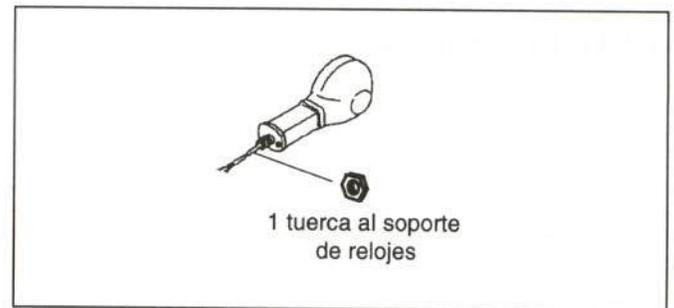
Figura 35.- Unión del intermitente delantero
