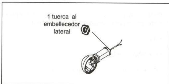
Figura 21.- Unión del intermitente trasero
