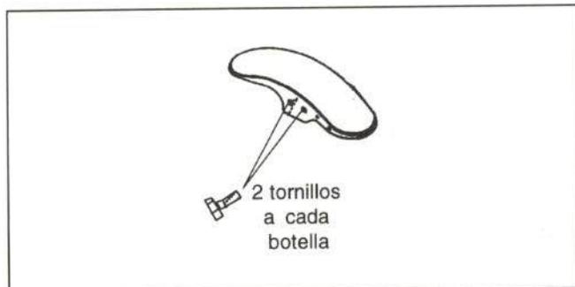
Figura 32.- Unión del guardabarros delantero
