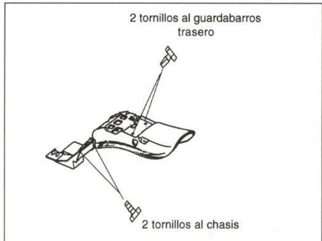
Figura 26.- Unión de la caja de batería
