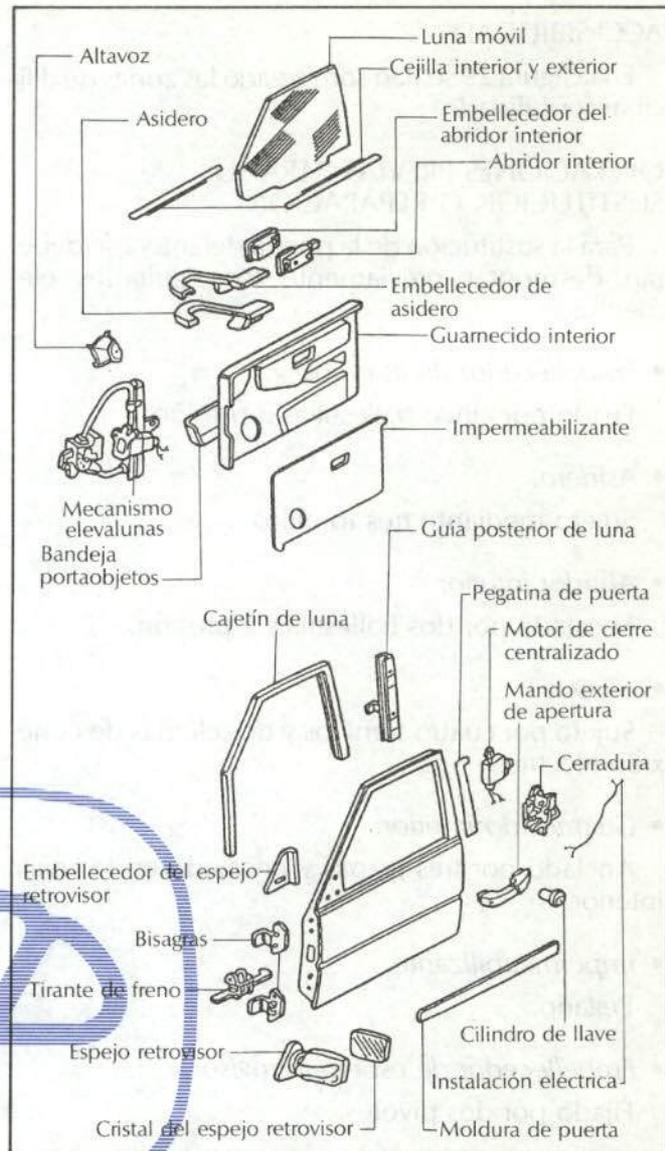
Fig. 30.—Elementos de la puerta delantera.
