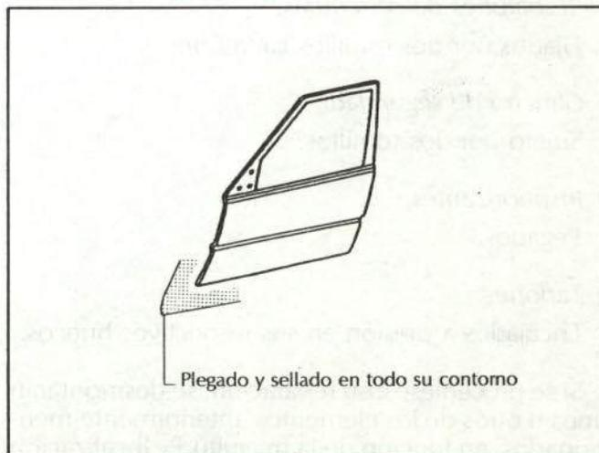
Fig. 28.—Unión del panel de puerta delantera.
