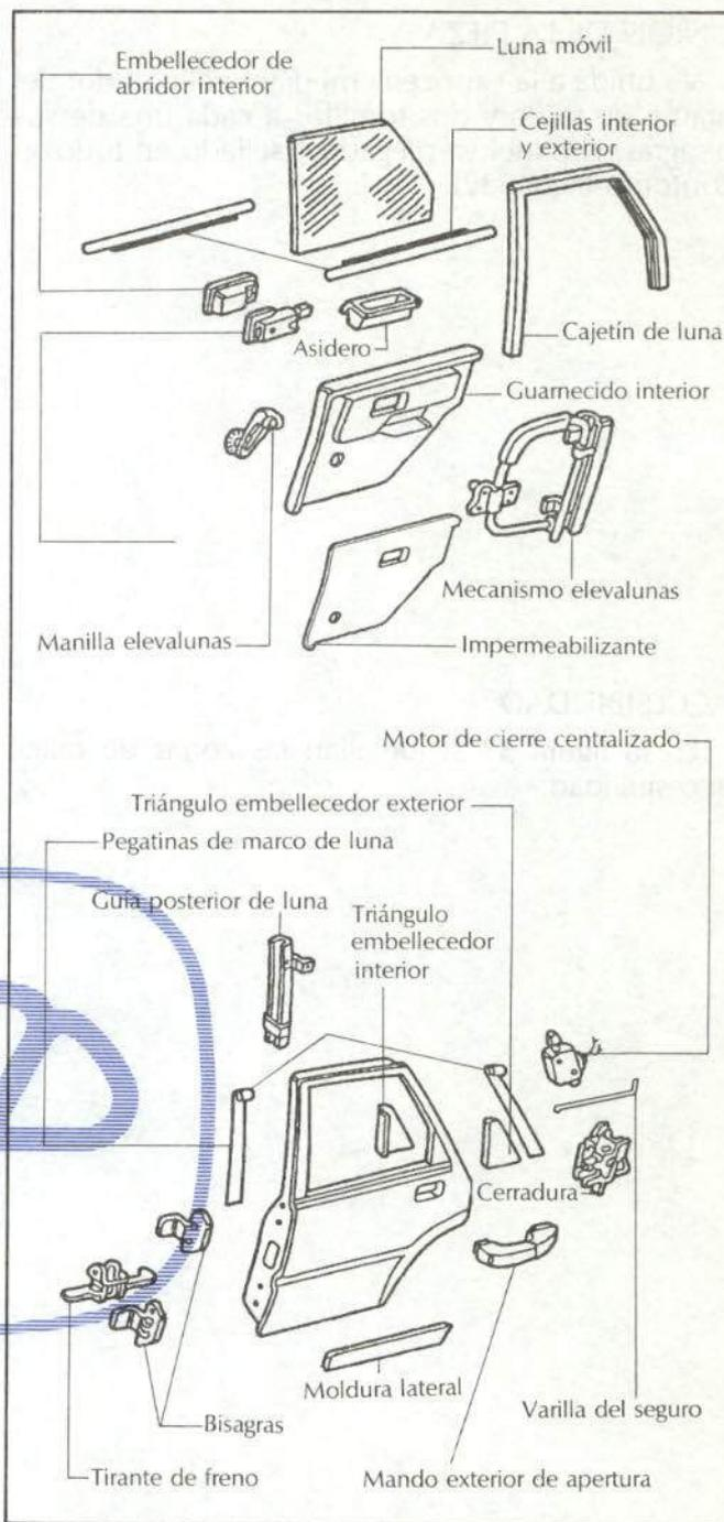
Fig. 34.—Elementos de la puerta trasera.
