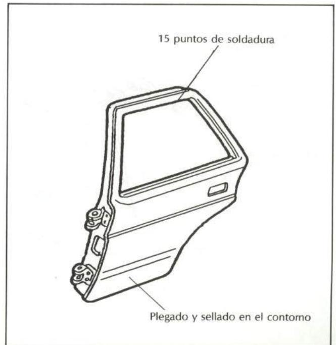
Fig. 25.—Unión del panel de puerta.
