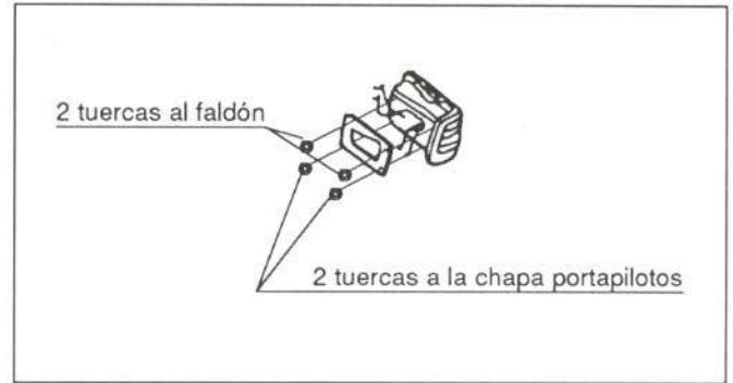
Figura 58.- Fijación de los pilotos traseros
