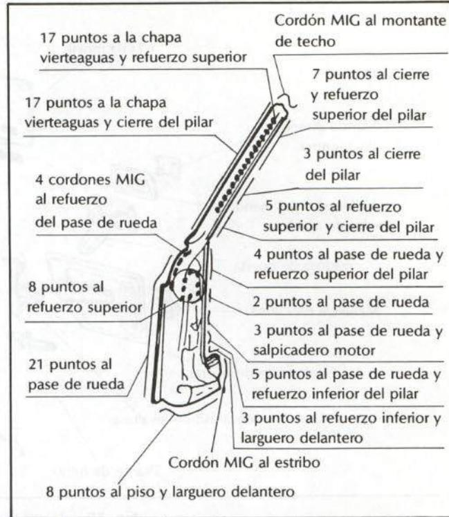
Fig. 41.—Unión del pilar delantero a carrocería.
