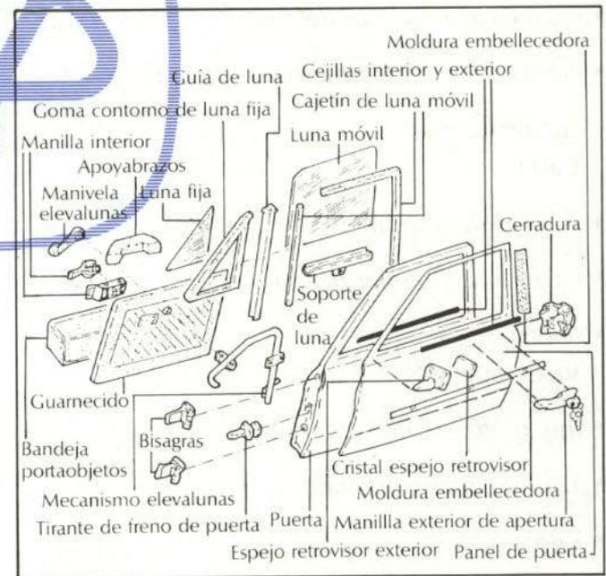
Fig. 34.—Elementos de la puerta delantera.
