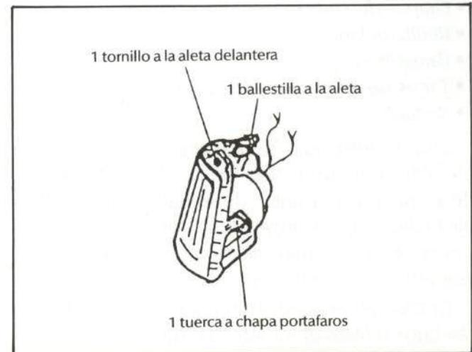
Fig. 15.—Fijación del piloto delantero.
