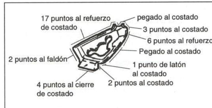
Figura 48.- Unión de la chapa portapiloto
