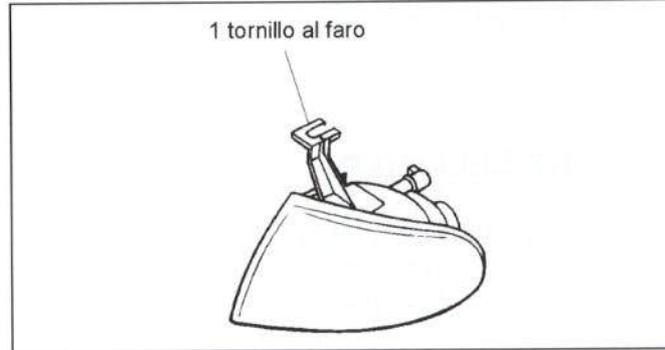
Figura 13.- Unión del piloto delantero
