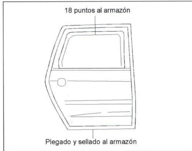
**Figura 33.-** Unión del panel de puerta trasera
