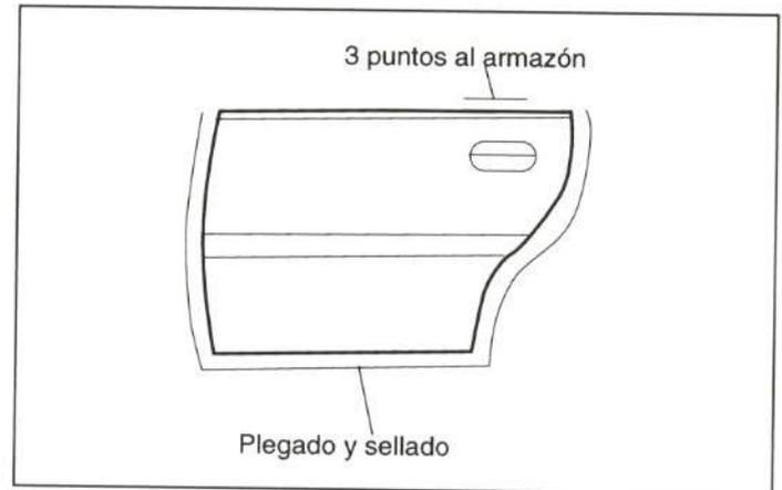
Figura 33.- Unión del panel de puerta delantera
