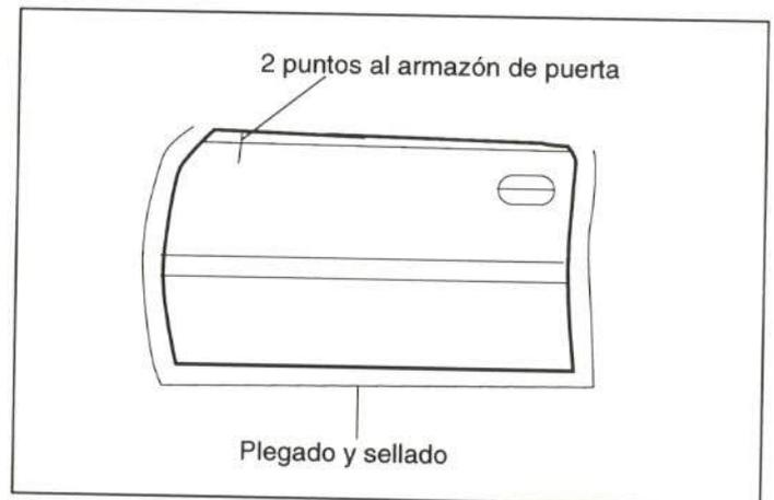
Figura 36.- Unión del panel de puerta trasera
