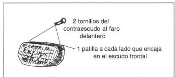
**Figura 31.-** Unión del faro delantero
