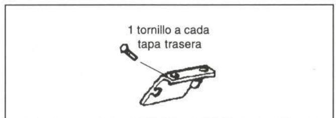
**Figura 21.-** Unión de la tapa de unión trasera
