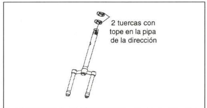
Figura 40.- Unión de la horquilla de dirección
