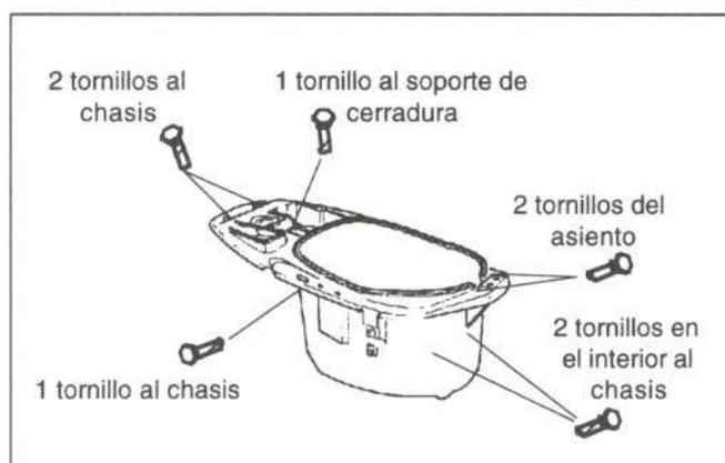
Figura 25.- Unión del portacascos
