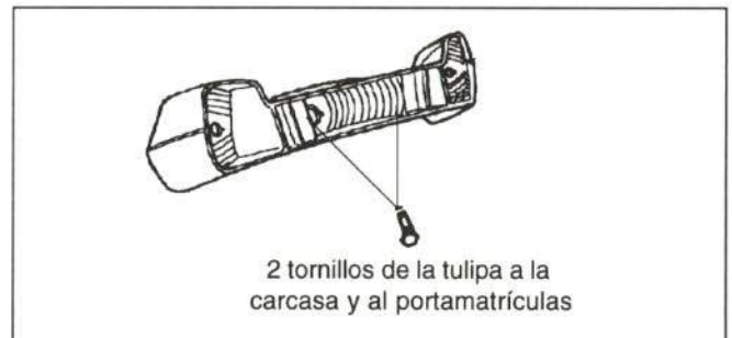
Figura 19.- Unión del piloto trasero
