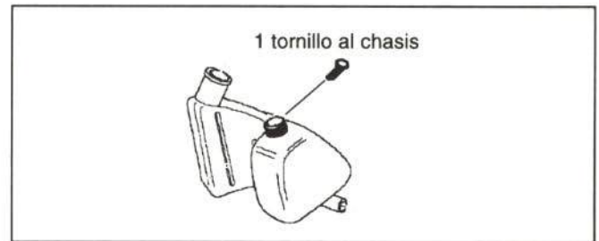
Figura 40.- Unión del depósito de aceite
