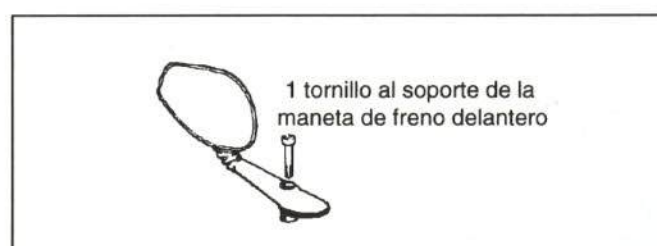
Figura 28.- Unión del espejo retrovisor
