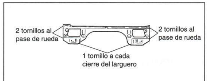
Figura 18.- Unión del frente delantero
