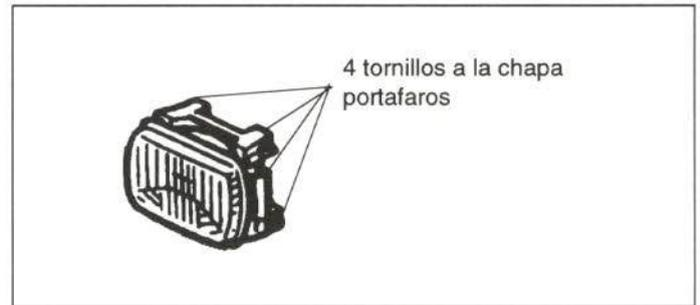
Figura 13.- Unión del faro
