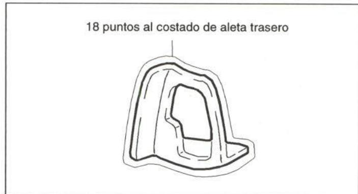
Figura 51.- Unión de la chapa portapiloto.
